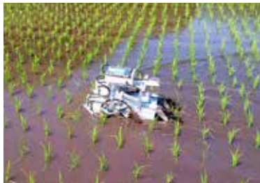
▲IKOMAロボットの「水田用除草ロボット」。小型で軽量、安価が特徴
