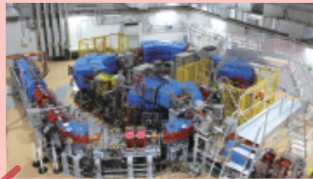
水素原子から陽子を取り出し、光速の70%まで加速します。加速されエネルギーを持った陽子(線)を回転ガントリーまで運びます。
