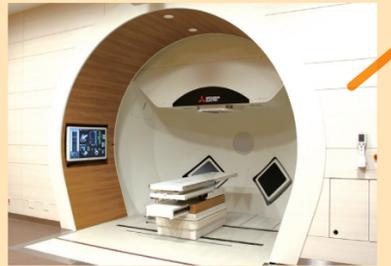
该设施拥有一个治疗室，并可采用多种不同照射方式（如散射法，扫描法），可以为患者选择最佳的照射方法。
