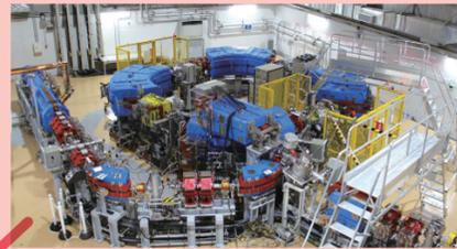
从氢原子中分离出质子，并将其加速到光速的70%左右后，输送到旋转机架。
